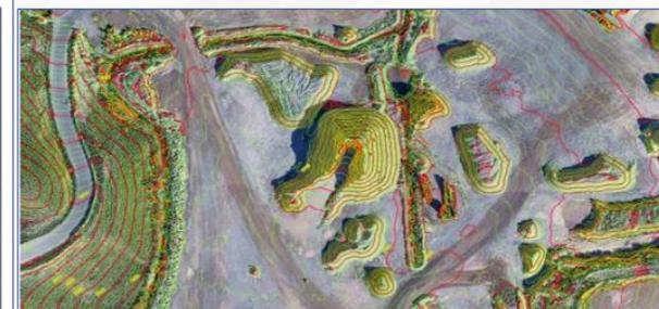
*Levantamiento Topográficos, DSM, Curvas de nivel.*
