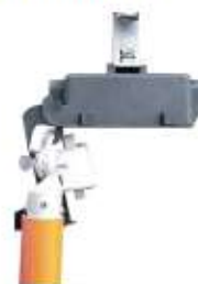
Colocación de brazo para cambio de fusibles
