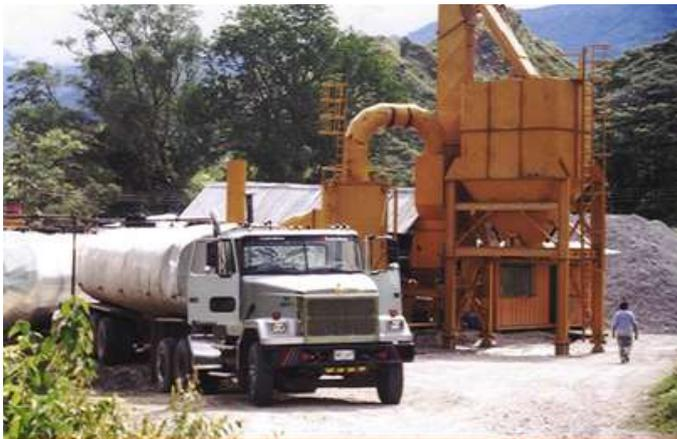
Planta de asfalto para la producción de base Y rodadura asfáltica para pavimentación de vías. **Produce 180 ton/hora.**
