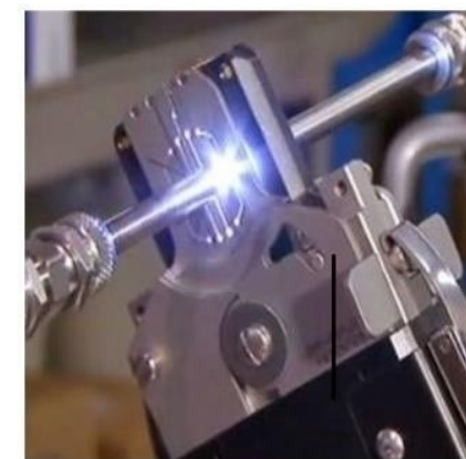
Proceso de Soldadura Orbital
