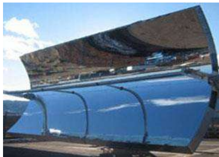
CIEMAT (PSA) Planta de pruebas de cilindros parabólicos Planta Piloto
