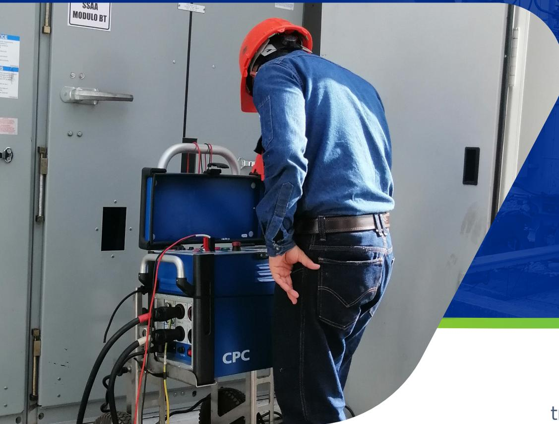
El **CPC 100** puede realizar pruebas eléctricas de transformadores de potencia, transformadores de corriente, transformadores de tensión, máquinas rotatorias, sistemas de puesta a tierra, líneas eléctricas, y cables, e interruptores de potencia.
