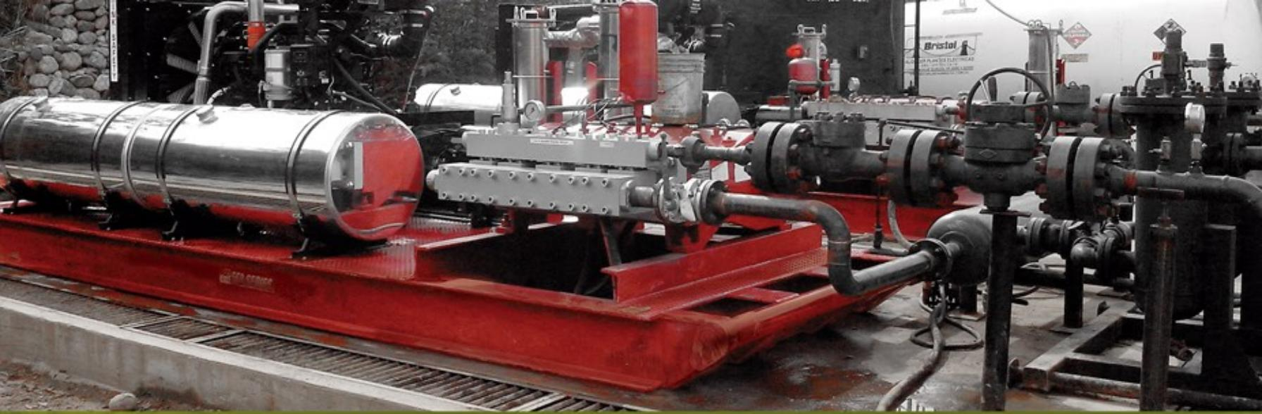
Bombas Quintuplex para inyección continua de agua de producción tipo jet de alta presión
