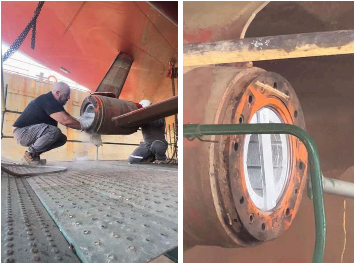
Foto 6. Instalación de bujes línea babor por el equipo de Ingenieros BALAM.
