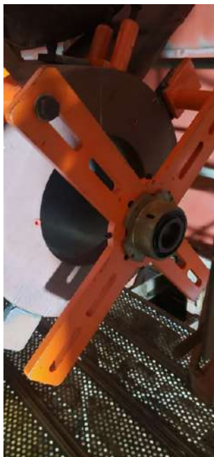
Foto 4. Montaje para mecanizado de portabujes proa, popa y central.
