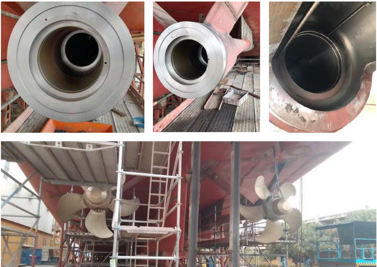
Foto 7. Inspección trabajo terminado y montaje de hélices.
