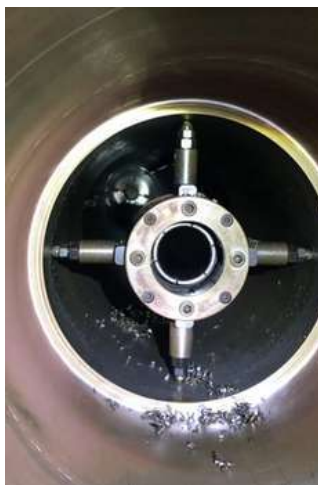
Foto 4. Montaje para mecanizado de portabujes proa, popa y central.
