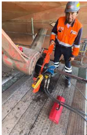
Foto 1. Montaje: Instalación de bases y accesorios de torno portátil Clímax BB5000 y sistema de alineación óptico.
