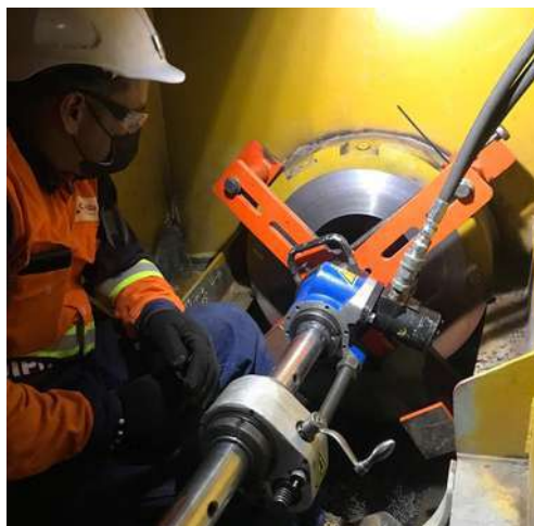
Foto 5. Mecanizado de portabujes proa, popa y central.
