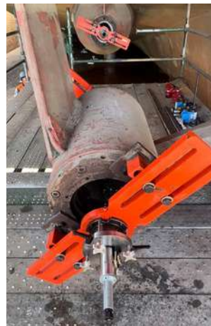
Foto 3. Mecanizado de portabuje codaste proa.
