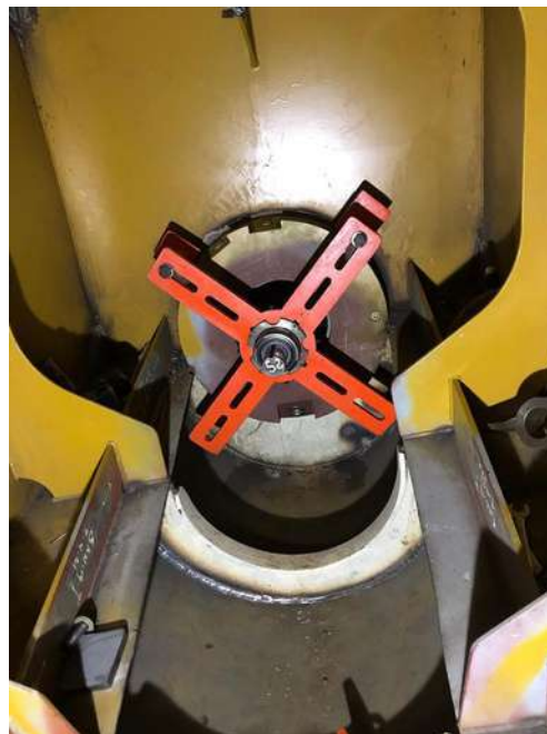
Foto 4. Montaje para mecanizado de portabujes proa, popa y central.
