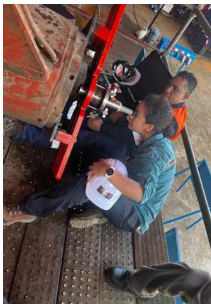
Foto 4. Alineación de porta bujes en línea babor con sistema óptico BRUNSON.
