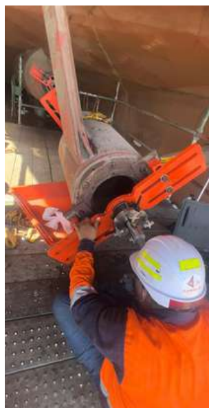
Foto 4. Alineación de porta bujes en línea babor con sistema óptico BRUNSON.
