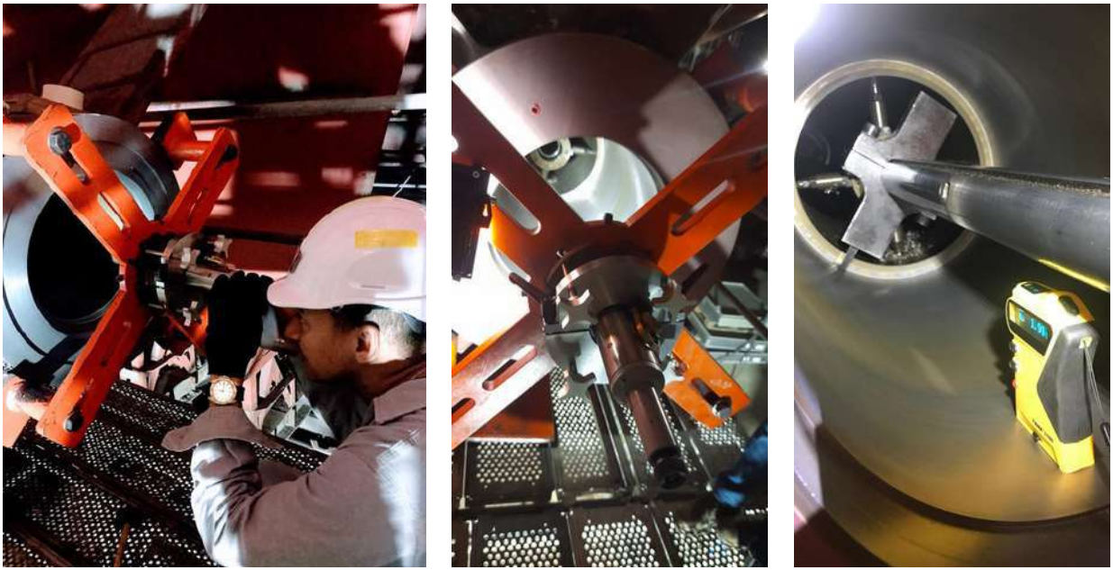
Foto 6. Verificación de alineación con sistema óptico BRUNSON y Rugosidad con Rugosímetro.
