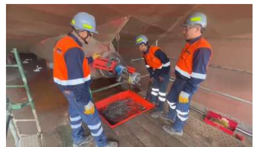
Foto 3. Mecanizado de portabuje codaste proa.
