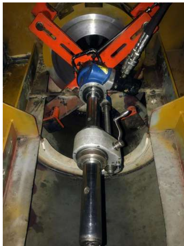
Foto 2. Mecanizado y refrentado de caras portabuje de arbotante estribor.
