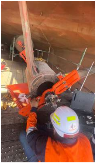
Foto 1. Montaje: Instalación de bases y accesorios de torno portátil Clímax BB5000 y sistema de alineación óptico.
