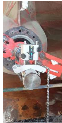
Foto 2. Alineación y verificación con láser del sistema de propulsión.
