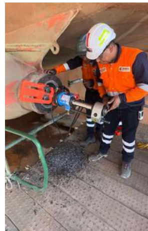
Foto 3. Mecanizado de portabuje codaste proa.
