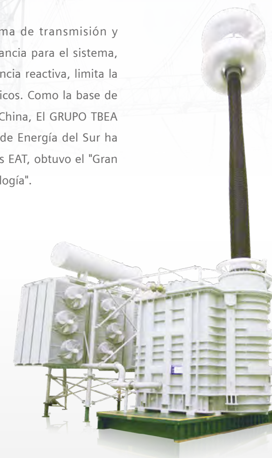
Reactor monofásico de 320MVA, 1100kV. El primer reactor monofásico de derivación de columna única con el nivel de tensión más alto y la mayor potencia del mundo, utilizado en la subestación Ximeng del proyecto de transformación y transmisión de CA EAT de Ximeng-Shengli.
