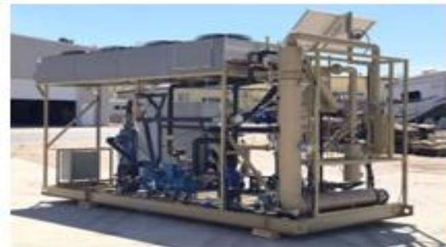
MÓDULO PORTABLE PARA ACONDICIONAMIENTO DE COMBUSTIBLE
