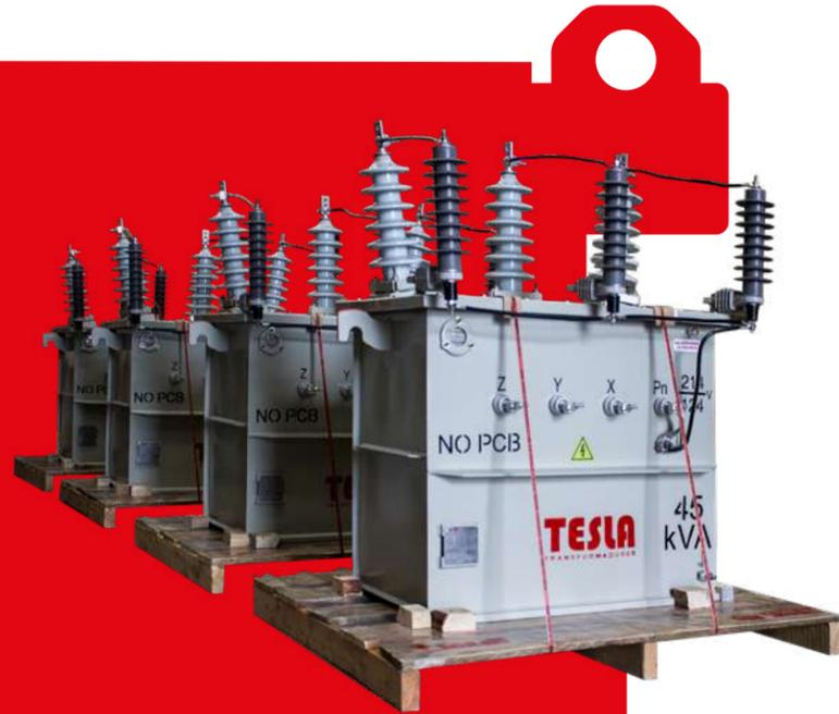
Estos transformadores son los más utilizados en las redes eléctricas actuales; sus devanados y núcleo magnético están sumergidos completamente en aceite dieléctrico, el cual además de ser un aislante, tiene la propiedad de servir de medio refrigerante para disipar el calor generado por la parte activa. Este tipo de transformadores no tienen limitantes de fabricación y tienen la particularidad de abarcar un gran rango de tensiones y por ende un gran rango de corrientes.
