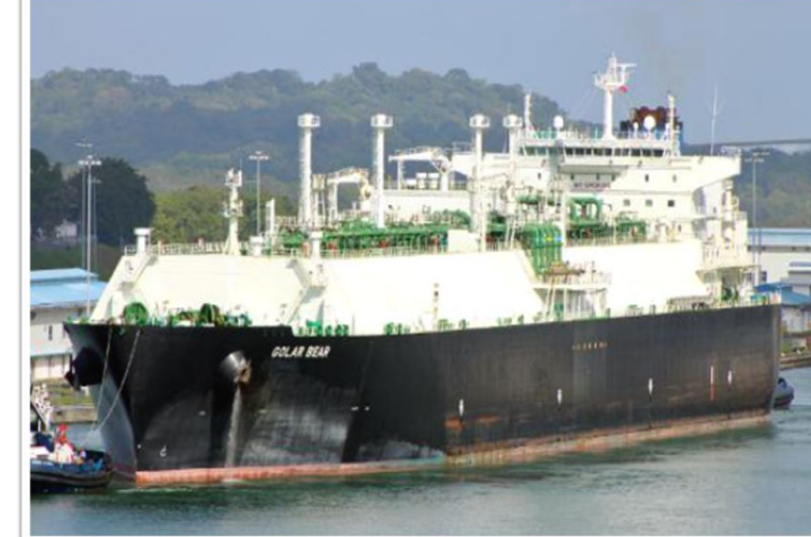
160,000 CBM LNG Carrier LNG Reliquefaction System FLAG – MARSHALL ISLAND
