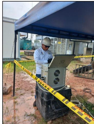
Pruebas VLF acometida bombas, TR y SWG (CPE-6)
