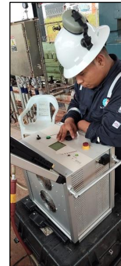
Prueba VLF a acometida de bomba Principal en la estación de bombeo CAÑO SUR
