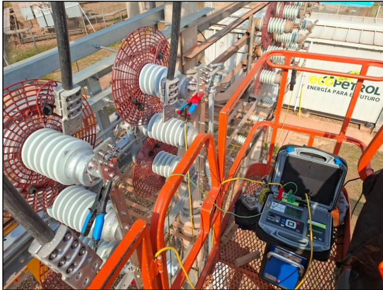
Prueba de seccionadores y reconectores Caño Sur – Centro de maniobras EP-1 Centauros
