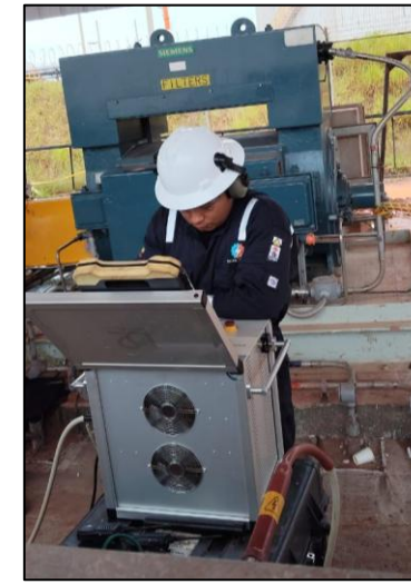
Prueba VLF a acometida de bomba Principal en la estación de bombeo CAÑO SUR
