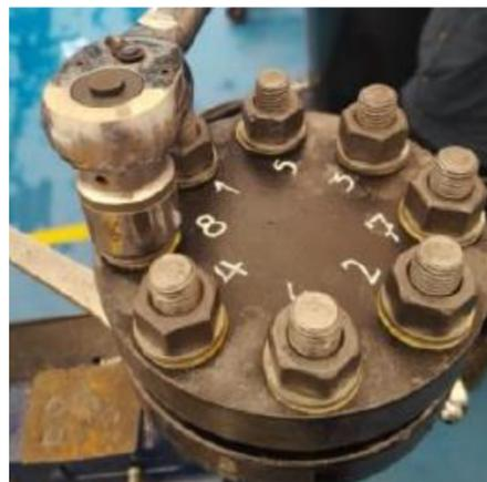
La prueba realizada demostró que la junta de aislamiento Ref. FSS (Full Sealing Service) de 2 In ANSI 1500, no presento fallas hasta una presión de 10.000 psi, manteniéndose durante una hora sin fugas. Se confirmó la continuidad eléctrica la cual arrojó un resultado de 0 ohmios, y el kit de aislamiento fue torquedo a 230 lb.ft.
