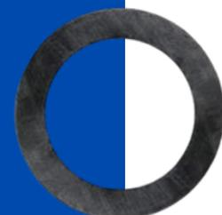
**EMPAQUE KAMMPROFILE**- Esta compuesta por un núcleo de metal sólido con ranuras dentadas concéntricamente mecanizadas en las caras superior e inferior. El núcleo de metal es típicamente de acero inoxidable. El núcleo dentado está cubierto con material de sellado suave (grafito flexible y PTFE expandido son las más comunes).
