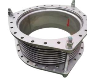
Las Juntas de Expansión Metálicas modelo JFM son personalizadas para diferentes necesidades, adecuadas para condiciones severas como altas temperaturas, presiones elevadas y medios no compatibles con elastómeros. Absorben movimientos axiales, laterales y angulares, pero no soportan movimiento torsión.
