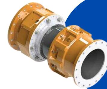
**2). Aumento repentino de la presión del flujo:** Donde los parámetros del sistema lo permitan, el MBC estándar se activará si se produce una sobrepresión interna extrema provocada por un acontecimiento inusual, como puede ser el cierre de una válvula por error flujo abajo. La presión de activación se configura de acuerdo a los parámetros operativos del sistema.
