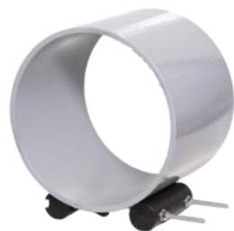
**INSPECT-A-LIFT®**, Este sistema ofrece una solución probada contra la corrosión entre la tubería y los soportes. Elimina hendiduras, facilita la inspección y previene acumulación de agua, conservando la pintura y eliminando la corrosión. Cumple con regulaciones de control de corrosión atmosférica, inspección de líquidos peligrosos y soportería para tuberías de gas y petróleo establecidas por el "DOT Office of Pipeline Safety Code of Federal Regulations".
