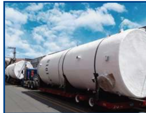
Tanques en resinas plásticas reforzadas con fibra de vidrio (PRFV)
