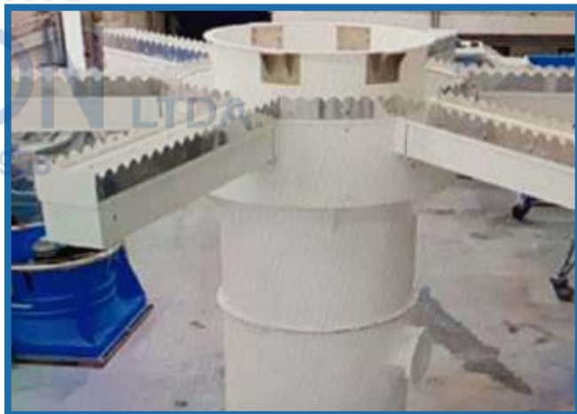
CLARIFICADOR DE SEDIMENTACIÓN ACELERADA (GUYANA)
