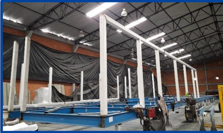
Metalmecánica pesada vigas y tubería ASTM A572/A500- Proceso GMAW (MIG)
