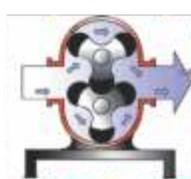
Rotores con diferentes diseños y materiales según producto. Extremos reemplazables
