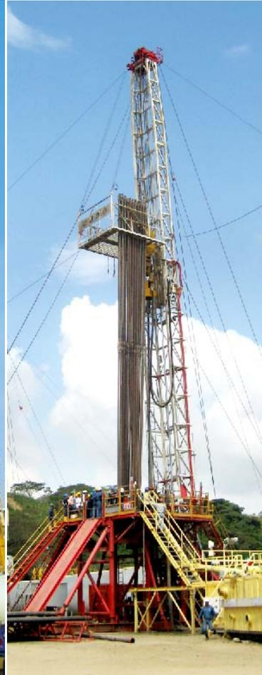
Equipo de perforación montado sobre camiones
