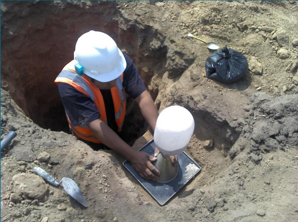
ENSAYO DE CONO DE ARENA PARA DENSIDAD – MINERA CERRO VERDE -
