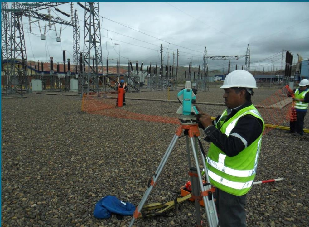
LEVANTAMIENTO TOPOGRAFICO Y CONTROL CON GPS – MONITOREO
