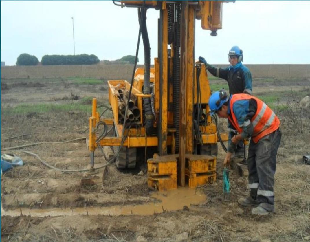
ENSAYO DE PERFORACIÓN CON DIAMANTINA PARA MUESTREO
