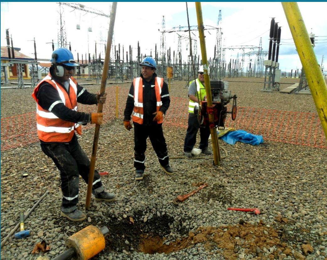
ENSAYO DE SPT – CAPACIDAD ADMISIBLE DEL TERRENO – MINERA XSTRATA
