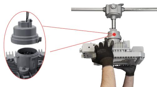
La instalación y el mantenimiento nunca han sido más sencillos gracias al sistema colgante de montaje rápido. Solo debe realizar el cableado previo de la cubierta de montaje, alinear las flechas hacia arriba y roscar la luminaria Baymaster en su lugar.
