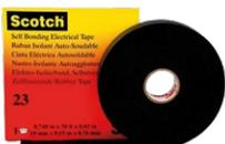
Cinta de caucho autofundente, para aislamiento primario hasta 69kV y sello contra humedad en media y baja tensión. Temperatura de operación entre 0°C y 130°C.
