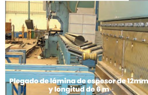
**Plegado de lámina de espesor de 12mm y longitud de 6 m**
