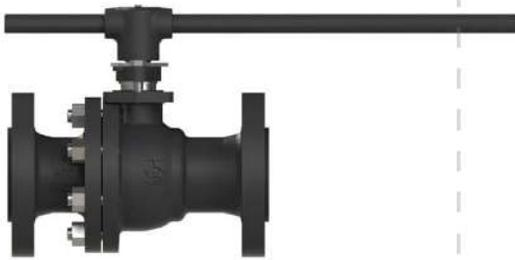
Válvula de bola flotante para servicio petrolero diseñada de acuerdo a los requerimientos API-6D / API-608. Construcción de cuerpo de dos piezas, fabricada a partir de fundición con extremos RF, RTJ o WE; válvula certificada a prueba de fuego de acuerdo con API-607. Su uso va desde petróleo y gas (API-6D, API-608) a prueba de fuego hasta servicios industriales donde se requiere la certificación a prueba de fuego, tales como refinerías, químicas o petroquímicas.
