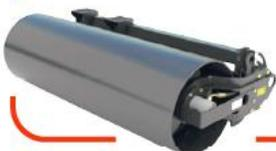
Utilizado para compactar y nivelar superficies de suelo o asfalto.
