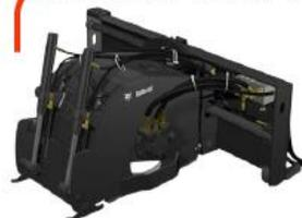
Utilizado para eliminar capas de asfalto y concreto de superficies.
