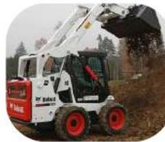
**CARACTERÍSTICAS:** MINICARGADOR DE LEVANTE VERTICAL, MOTOR TURBOCARGADO, MAYOR ALTURA Y CAPACIDAD DE CARGA.
