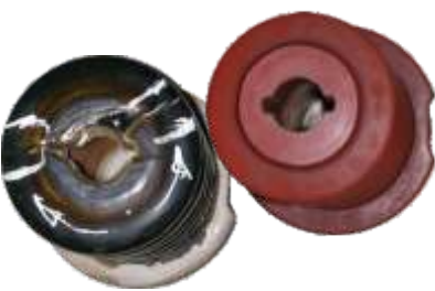
Pieza en resina epóxica a partir de modelo dañado
