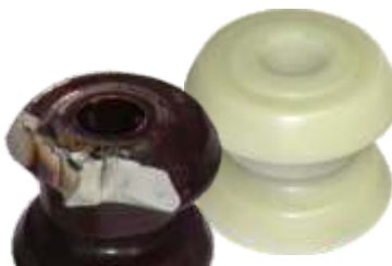
Aislador en Fibrapox a partir de modelo roto
