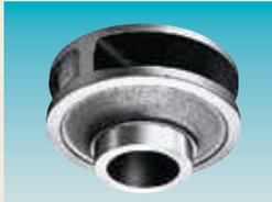
Es un impulsor semiabierto con uno o dos álabes. Tiene un canal ancho desde la admisión hasta la salida, que permite el paso de sólidos con mínima interferencia del flujo.
