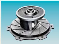
El impulsor es del tipo semiabierto con un ábete. Una hoja de carburo de tungsteno sinterizado integrado al ábete del impulsor y gira sobre la tapa de succión dentada. Este mecanismo corta los sólidos que entran al impulsor para facilitar su descarga.
