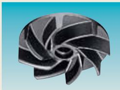
Cuando gira, el impulsor tipo vórtice produce un movimiento de remolino por fuerza centrífuga entre el impulsor y el armazón de la bomba. Con un armazón de bomba grande, este mecanismo facilita el paso de sólidos y materiales fibrosos sin interferir en el flujo.
