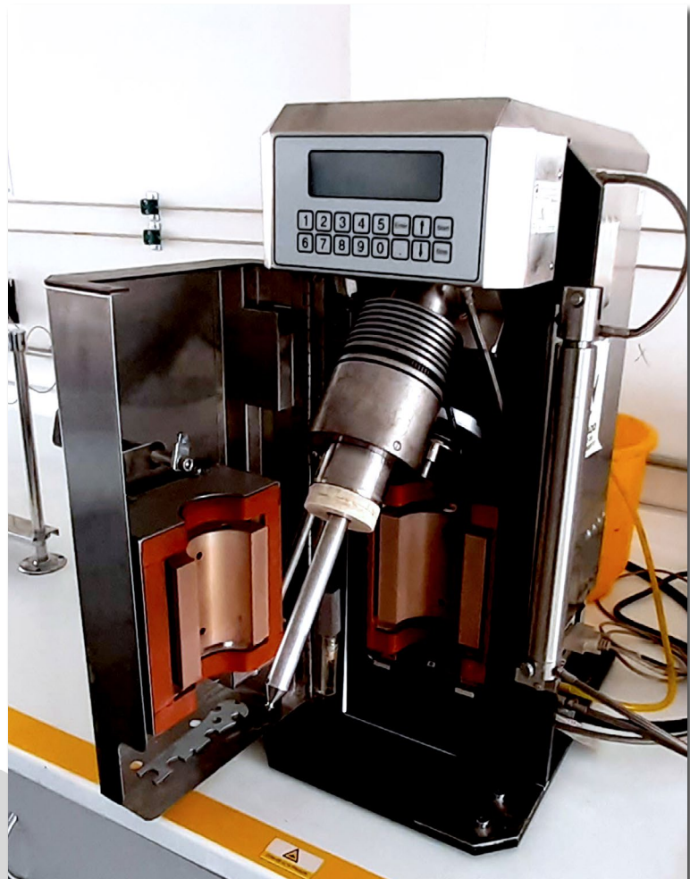
Filtración Dinámica - FANN 90
