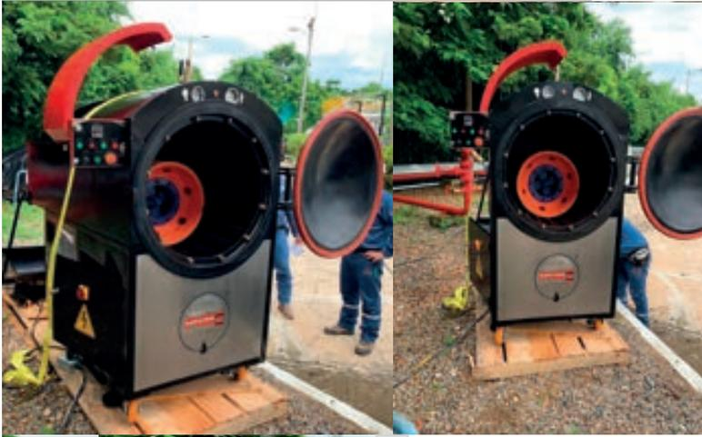
LANZADOR Y BANDEJA RECOLECTORA DE RASPADORES
