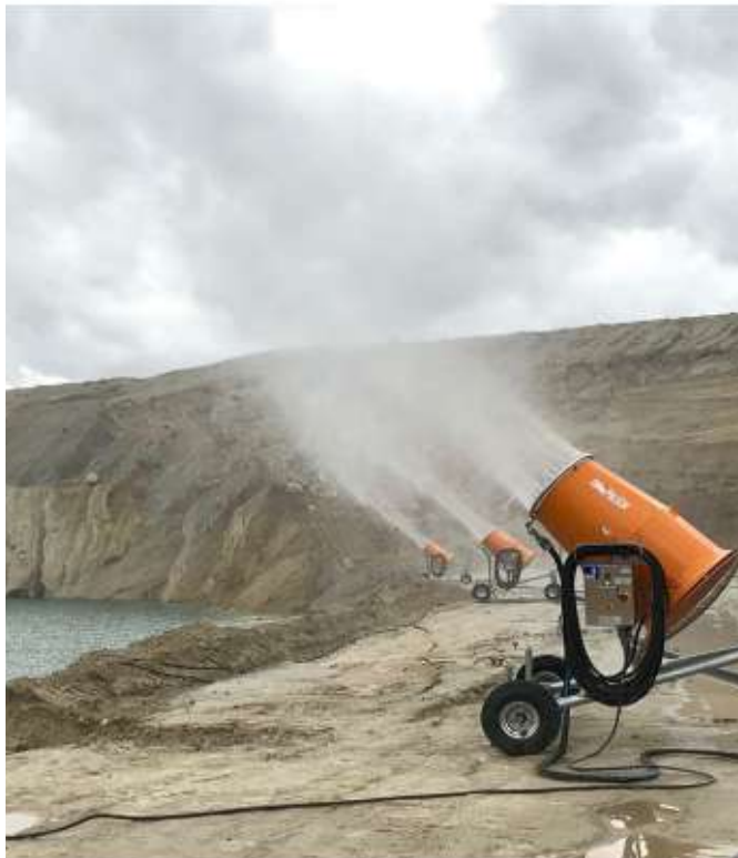
Disposición de aguas residuales industriales y domésticas por Evaporación Mecánica
