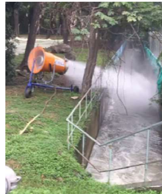
Enfriamiento acelerado de aguas para reúso en generación de energía y de producción
