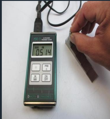
INSPECCIÓN MEDICIÓN DE ESPESORES
