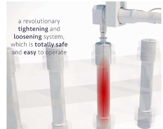
Para la **extracción** e **instalación** de pernos y espárragos de gran tamaño en carcasas de turbinas de gas, turbinas de vapor y otras aplicaciones en equipos estáticos, como intercambiadores de calor. Adecuado para tamaños de agujeros a partir de  $\varnothing 9$  mm hasta 32 mm, y longitudes de hasta 1500 mm.
