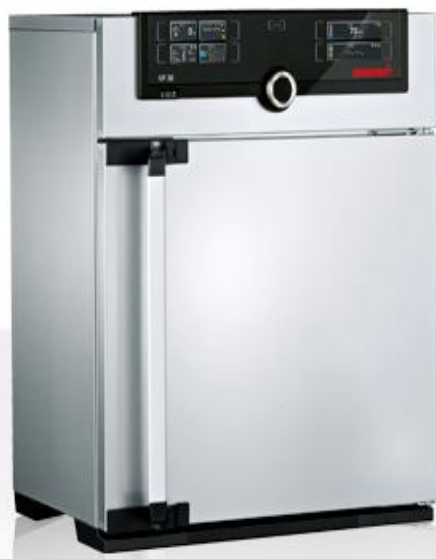
Estufa de parafina UNpa con TwinDISPLAY Software AtmoCONTROL Tamaños de los modelos: 30 / 55 / 75 / 110 / 160 de +30 °C a +80 °C
