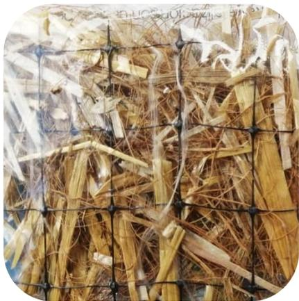
Los mantos control de erosión pueden proveer soluciones a cualquier tipo de problema de sedimentos y erosión. Las soluciones van desde productos con degradación acelerada, para aplicaciones residenciales o aplicaciones paisajísticas, hasta mantos de control de erosión para soluciones permanentes en canales de flujo alto
